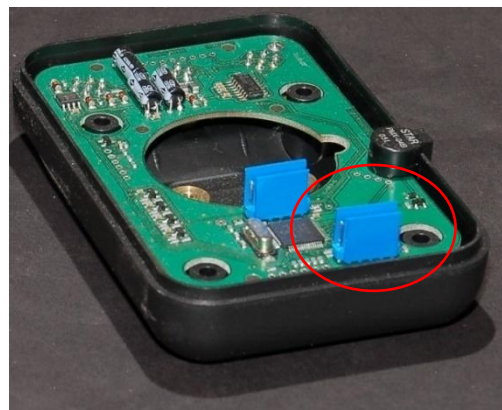
Anschlussbrücke für 6-Pin-Adapter bei Joystickeinheit
