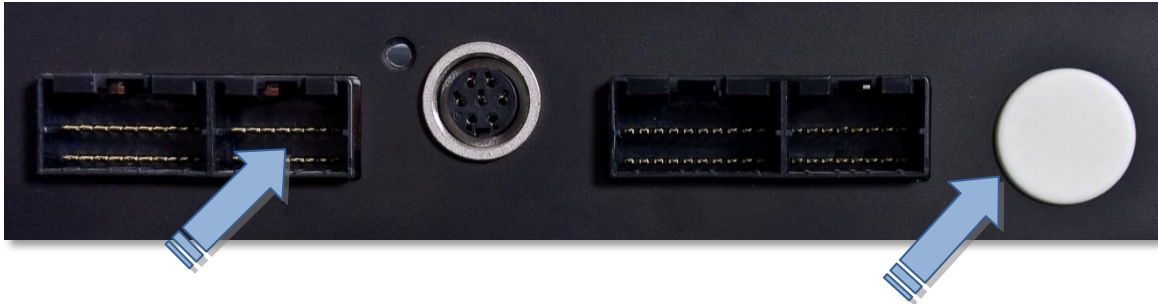
Zum Firmware Update Stecker für Lenkservo entfernen (linker Pfeil) und RJ-Western-Stecker anschließen (rechter Pfeil)
